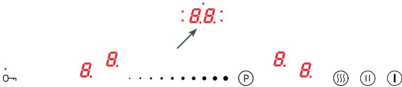
O relógio facilita o processo de cozedura graças à possibilidade de programar o tempo de funcionamento das áreas de cozimento. Também pode servir como temporizador. A função de temporizador só pode ser ativada durante o cozimento (quando a saída de aquecimento for maior que "0"). Você pode usar a função de temporizador simultaneamente em todos os campos de aquecimento. O tempo máximo de trabalho é de 99 minutos (a cada 1 minuto). Para configurar o tempo do relógio, deve:
