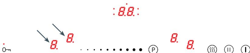
Graças à função Bridge você pode controlar 2 zonas de cozadura da placa como uma área de cozadura. A função Bridge é muito confortável, particularmente quando utilizador tachos tipo caçarola para a cozadura.
