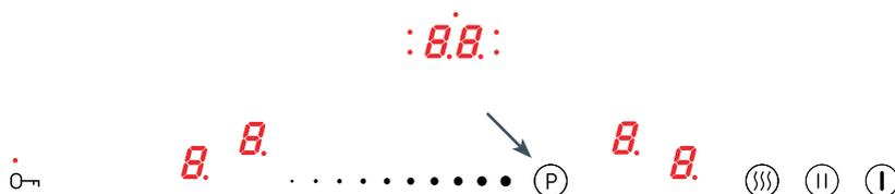
A função Booster aumenta a potência da área de 220x190mm - de 2200W para 3700W e da área Bridge (220 x 390mm) de 3600W para 5500W.
