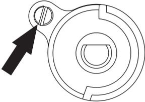
Para verificar a chama, deve aquecer o queimador com a chama completa durante cerca de 10 min., seguidamente mover a maçaneta da válvula para a chama econômica.
