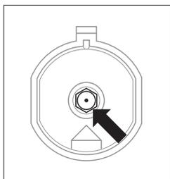
Troca do bocal do queimador superficial - desapertar o bocal com uma chave de caixa especial 7 e trocar com um bocal novo dependendo do tipo de gás (consultar a tabela acima).
