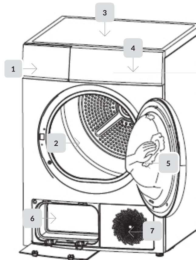
1. Depósito para condensado
